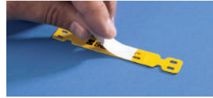
3. Scellez le support en appuyant d'un doigt sur le film et en poussant vers l'avant, de manière à le dérouler tout en décollant le support en silicone.
