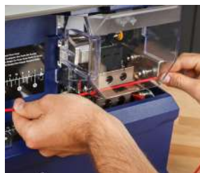
Sélectionnez une tâche, insérez le fil ou le câble
