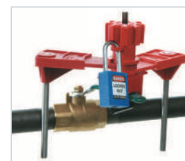
Utilisez deux armes de blocage pour bloquer les vannes de 3, 4 ou 5 voies, ou pour bloquer des vannes en position entrouverte pour contrôler leur fonctionnement.
